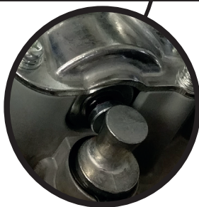
Posición del motor desbloqueado : La espiga tiene que estar en posición pulsada
