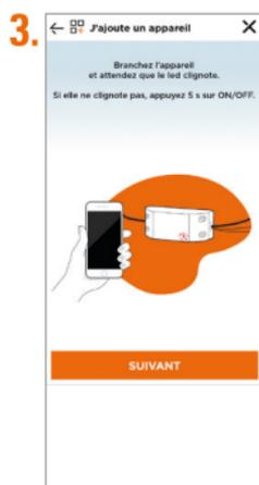
Brancher l'appareil et attendre que la LED clignote. Si elle ne clignote pas, appuyer 5 sec sur le bouton ON/OFF. Appuyer sur SUIVANT
