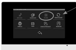
1/ Lorsque l'un des moniteurs est en conversation avec la platine de rue, les icônes «interphone», «caméra» et «écran» ne seront pas accessibles sur les autres moniteurs. Elles apparaissent en gris.
