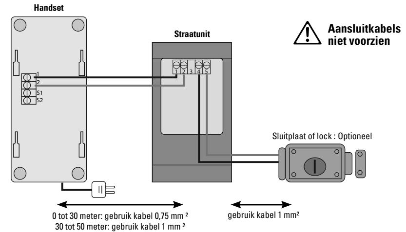
0 tot 30 meter: gebruik kabel 0,75 mm<sup>2</sup>
