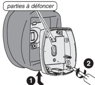
**(e)** Desserrez la vis de blocage de la rotule pour orienter le socle, puis bloquez la vis.
