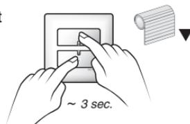
**Sur le récepteur**, appuyez simultanément sur les touches  $\triangle$  et  $\nabla$ , jusqu'à ce que le voyant clignote (~3 secondes).
