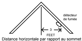
Photo 5 : En présentation, l'endroit où placer le détecteur avec un plafond inégal.
