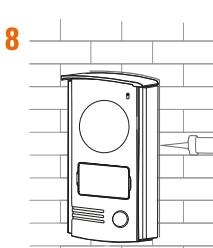
Después la instalación y prueba, colocar un junta de silicone transparente sin ácido arriba y sobre los lados de la placa exterior (no abajo) para evitar los riesgos de infiltración.
