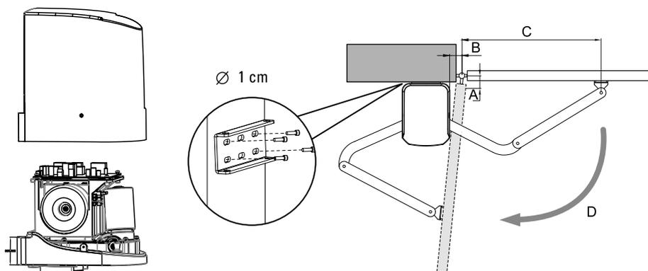
Installez le moteur sur la plaque de fixation en U avec les vis n°8 et écrous correspondants.
