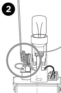
Si vous souhaitez améliorer la portée de vos télécommandes, vous pouvez brancher l'antenne située dans le feu clignotant avec un câble coaxial type RG58 (non fourni). Dans ce cas, vous devez déconnecter l'antenne d'origine. Branchez le cuivre central du câble coaxial sur la borne «ANT» et la tresse sur la borne «GND», côté antenne et côté carte électronique.
