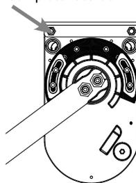
Ajustement porte ouverte : lorsque la position d'ouverture complète est définie, fixez la butée mécanique correspondante.
