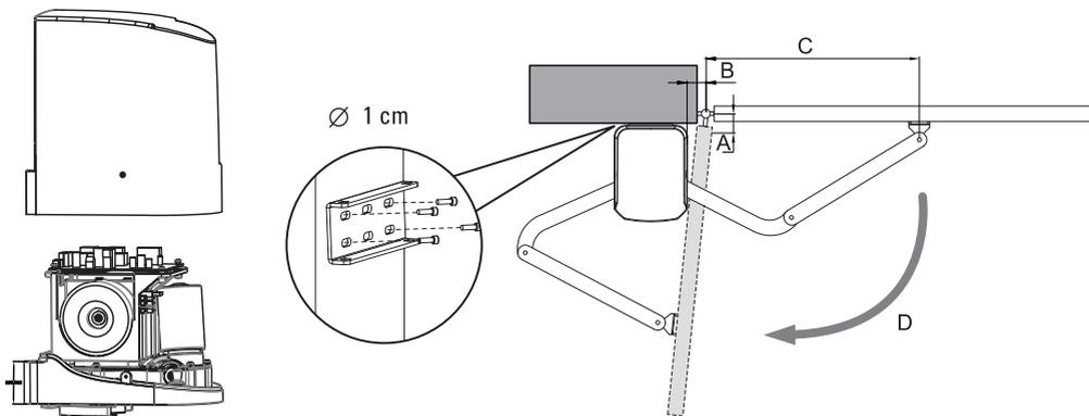
Installez le moteur sur la plaque de fixation en U avec les vis n°8 et écrous correspondants.
