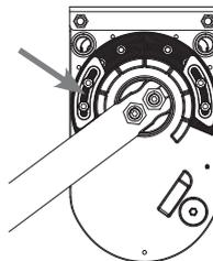
Ajustement porte ouverte : lorsque la position d'ouverture complète est définie, fixez la butée mécanique correspondante.
