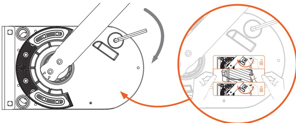
Fixer de façon permanente auprès de l'organe de manoeuvre du dispositif de débrayage manuel, l'étiquette relative à ce dispositif.
