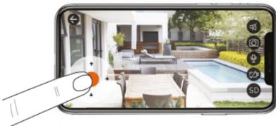
Un ángulo de visión de 75° y un ángulo de rotación de 300° permiten alcanzar un campo de visión de 360°. Para eso, basta con girar la cámara con las flechas desde la aplicación.
