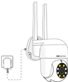
Branchez l'alimentation de la caméra et placez la à proximité de votre routeur Wi-Fi. Votre téléphone doit être connecté au même réseau Wi-Fi que votre caméra et la localisation doit être activée. Attendez le signal sonore.
