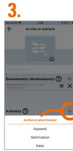
3. Pour sélectionner une ou des actions (appareil, notification ou délai) appuyer sur +
