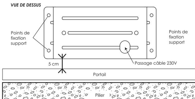
Percez votre support béton et installez vos 4 chevilles métalliques ou à scellement chimique pour fixer votre plaque de support moteur. Passez tous les câbles d'alimentation et d'accessoires. Assurez-vous à l'aide d'un niveau à bulle que la plaque de fixation du moteur soit bien de niveau. Positionnez votre moteur et boulonnez le avec les deux vis fournies.
