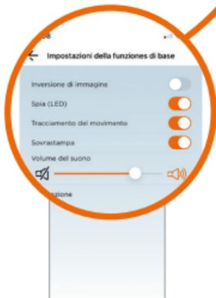
**Selezionare "Spia"** per disattivare il LED di stato.
