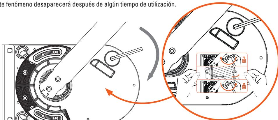
Hay que pegar de forma permanente la etiqueta del dispositivo de accionamiento manual en el elemento de control del dispositivo.
