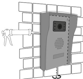
Trás la instalación y prueba, colocar una junta de silicona transparente sin ácido por arriba y de cada lado de la placa exterior (no abajo) para evitar los riesgos de infiltración.
