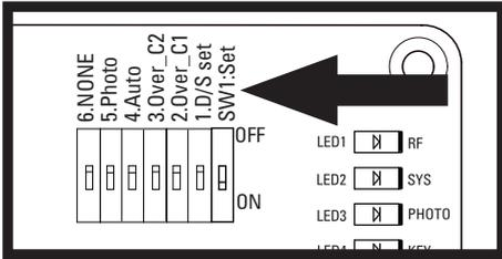
**Ajustes de los switches :** la posición «ON» se sitúa hacia la derecha, «OFF» hacia la izquierda.
