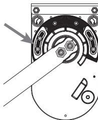
Ajuste puerta abierta : una vez la posición de apertura completa bien definida, fijar el tope mecánico correspondiente.
