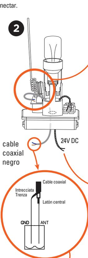
Para mejorar el alcance de sus controles remotos, se puede conectar la antena situada en la luz intermitente con un cable coaxial tipo RG58 (no suministrado). En este caso, hay que desconectar la antena de origen. Conectar el latón central del cable coaxial sobre la borna «ANT» y la trenza sobre la borna «GND», de cada lado (antena y tarjeta).
