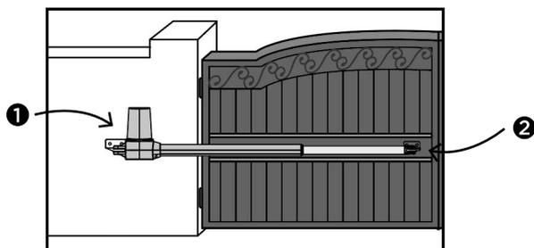
**1** Fijar el primer soporte al pilar. Colocar el automatismo en el soporte, luego colocar el tornillo y la tuerca.
