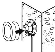
Después del cableado de sus fotocélulas, modificar el programa H y ajustarlo en H-1 para que sus fotocélulas se activen. Si no, no tendrán ningún efecto sobre el funcionamiento de su automatismo.
