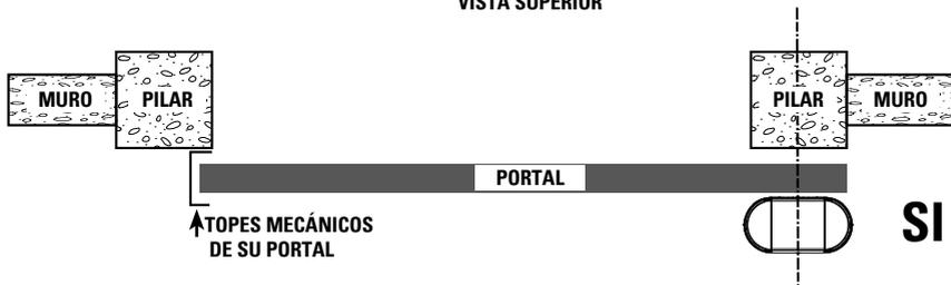
El borde de la placa de fijación se debe situar a 5 cm del borde del portal :
