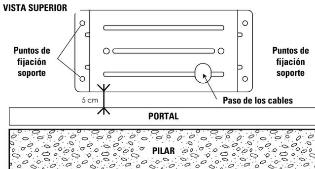
Perforar la base de soporte de hormigón e instalar los 4 tornillos metálicos o químicos para fijar su placa de soporte motor. Pasar todos los cables de alimentación y de accesorios. Asegurarse, con ayuda de un nivel a burbuja de que la placa de fijación del motor esté bien nivelado. Posicionar el motor y fijarlo con los dos tornillos incluidos.
