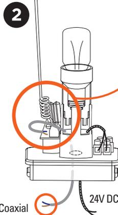
Si vous souhaitez améliorer la portée de vos télécommandes, vous pouvez brancher l'antenne située dans le feu clignotant avec un câble coaxial type RG58 (non fourni). Dans ce cas, vous devez déconnecter l'antenne d'origine. Branchez le cuivre central du câble coaxial sur la borne «ANT» et la tresse sur la borne «GND», côté antenne et côté carte électronique.
