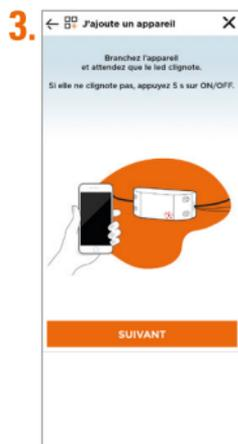
Brancher l'appareil et attendre que la LED clignote. Si elle ne clignote pas, appuyer 5 sec sur le bouton ON/OFF. Appuyer sur SUIVANT
