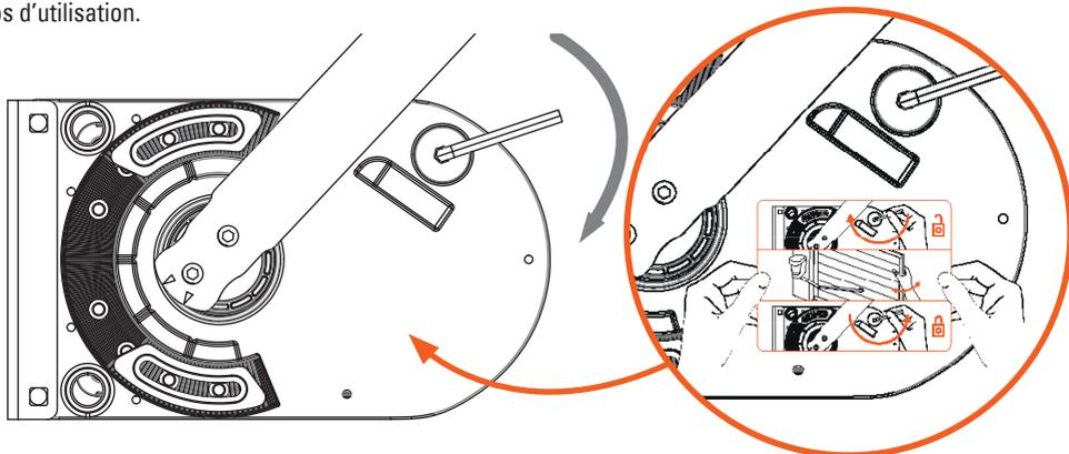
Fixez l'étiquette relative au dispositif de débrayage manuel de façon permanente auprès de l'organe de manœuvre.
