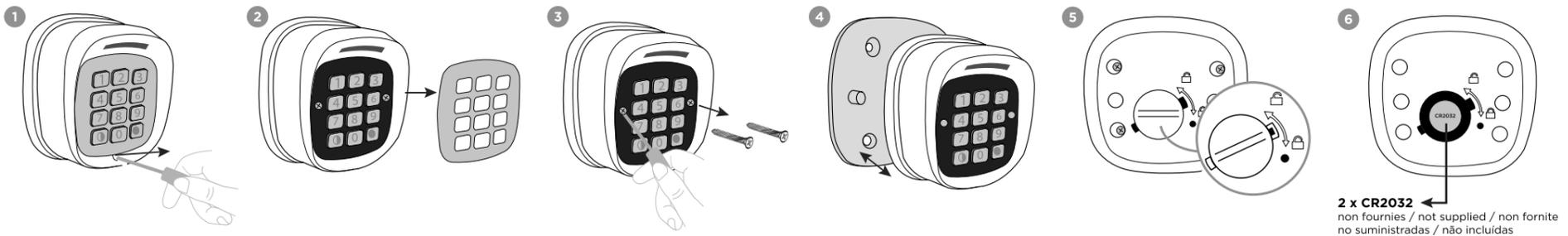
**FR.** Programmer puis tester le clavier à l'emplacement souhaité avant de l'installer **EN.** Program and test the keypad in the desired location before installing it **IT.** Programmare e testare la tastiera nella posizione desiderata prima di installarla **ES.** Programe y pruebe el teclado en la ubicación deseada antes de instalarlo **PT.** Programar e testar o teclado no local pretendido antes de o instalar
