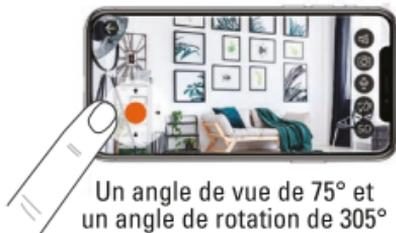
Un angle de vue de 75° et un angle de rotation de 305° permettent d'atteindre un champ de vision de 360°. Pour cela il suffit de faire tourner la caméra à l'aide des flèches depuis l'application.
