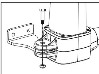
❷ Assemblez le deuxième support avec l'autre côté de l'automatisme puis vissez le support sur le portail fermé.
