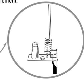
Si vous souhaitez améliorer la portée de vos télécommandes, vous pouvez brancher l'antenne située dans le feu clignotant avec un câble coaxial type RG58 (non fourni). Dans ce cas, vous devez déconnecter l'antenne d'origine. Branchez le cuivre central du câble coaxial sur la borne «ANT» et la tresse sur la borne «GND», côté antenne et côté carte électronique.
