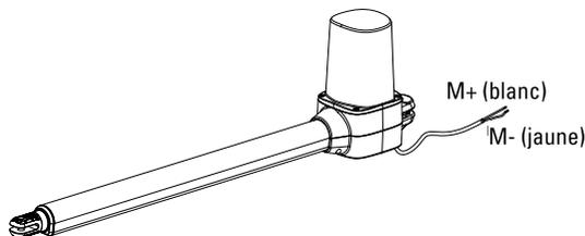
Remarque : Assurez-vous que les fils blanc et jaune soient dénudés de 5 mm. Evitez que le câble soit trop tendu pendant la phase d'ouverture et de fermeture.
