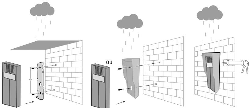
Après installation et test, placer un joint silicone transparent sans acide sur le haut et les côtés de la platine de rue (pas sur le bas) pour éviter tout risque d'infiltration.
