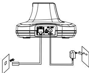
Brancher l'extrémité du cordon de la ligne téléphonique sur la prise de la base, puis brancher l'autre côté vers la prise téléphonique murale. Brancher l'extrémité de l'adaptateur sur la prise d'alimentation de la base, puis brancher l'autre côté sur la prise secteur.
