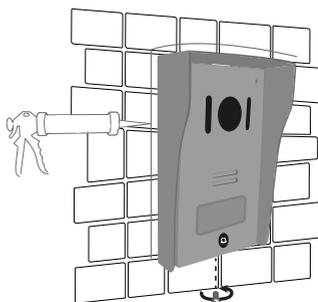
Después la instalación y prueba, colocar un junta de silicone transparente sin ácido arriba y sobre los lados de la placa exterior (no abajo) para evitar los riesgos de infiltración.
