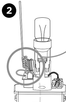
Si vous souhaitez améliorer la portée de vos télécommandes, vous pouvez brancher l'antenne située dans le feu clignotant avec un câble coaxial type RG58 (non fourni). Dans ce cas, vous devez déconnecter l'antenne d'origine. Branchez le cuivre central du câble coaxial sur la borne «ANT» et la tresse sur la borne «GND», côté antenne et côté carte électronique.
