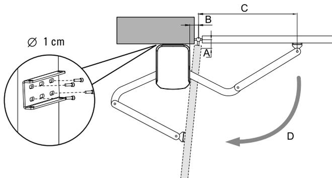
Instalar el motor en la placa de fijación en forma de U con los tornillos nº8 y tuercas correspondientes.
