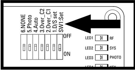
**Ajustes de los switches :** la posición «ON» se situa hacia la derecha, «OFF» hacia la izquierda.
