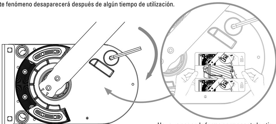
Hay que pegar de forma permanente la etiqueta del dispositivo de accionamiento manual en el elemento de control del dispositivo.
