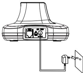
Brancher l'extrémité de l'adaptateur sur la prise d'alimentation de la base, puis brancher l'autre côté sur la prise secteur
