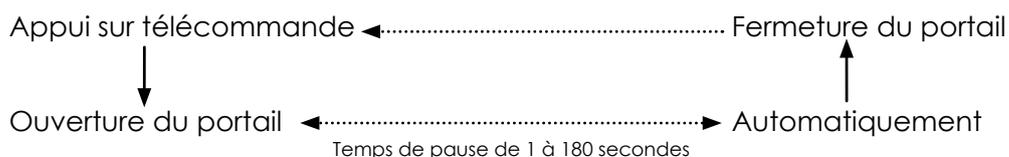
**Avec ce mode, vous n'utilisez votre télécommande que pour ouvrir le portail. La fermeture s'effectuera automatiquement. Ce mode de fonctionnement nécessite l'installation des photocellules.**
