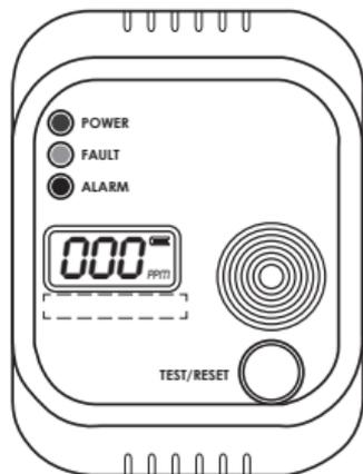
**Ce détecteur avertisseur autonome de monoxyde de carbone est indispensable pour signaler rapidement tout risque vital lié au monoxyde de carbone.**
