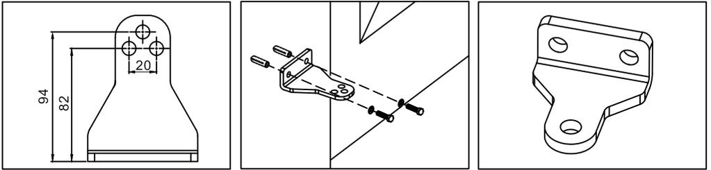
Colocar el automatismo en el soporte, poner el pasador según los planes de montaje no.1 y no.2
