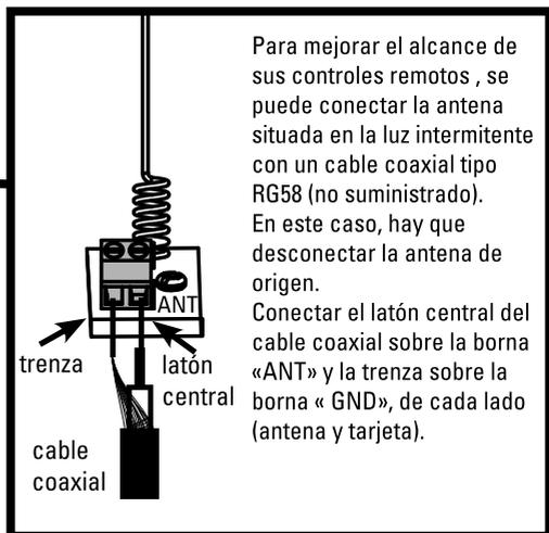
Para mejorar el alcance de sus controles remotos, se puede conectar la antena situada en la luz intermitente con un cable coaxial tipo RG58 (no suministrado). En este caso, hay que desconectar la antena de origen. Conectar el latón central del cable coaxial sobre la borna «ANT» y la trenza sobre la borna «GND», de cada lado (antena y tarjeta).
