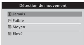
Entrer dans le menu " Détection de mouvement ". Choisir le niveau de détection souhaité avec les boutons .
