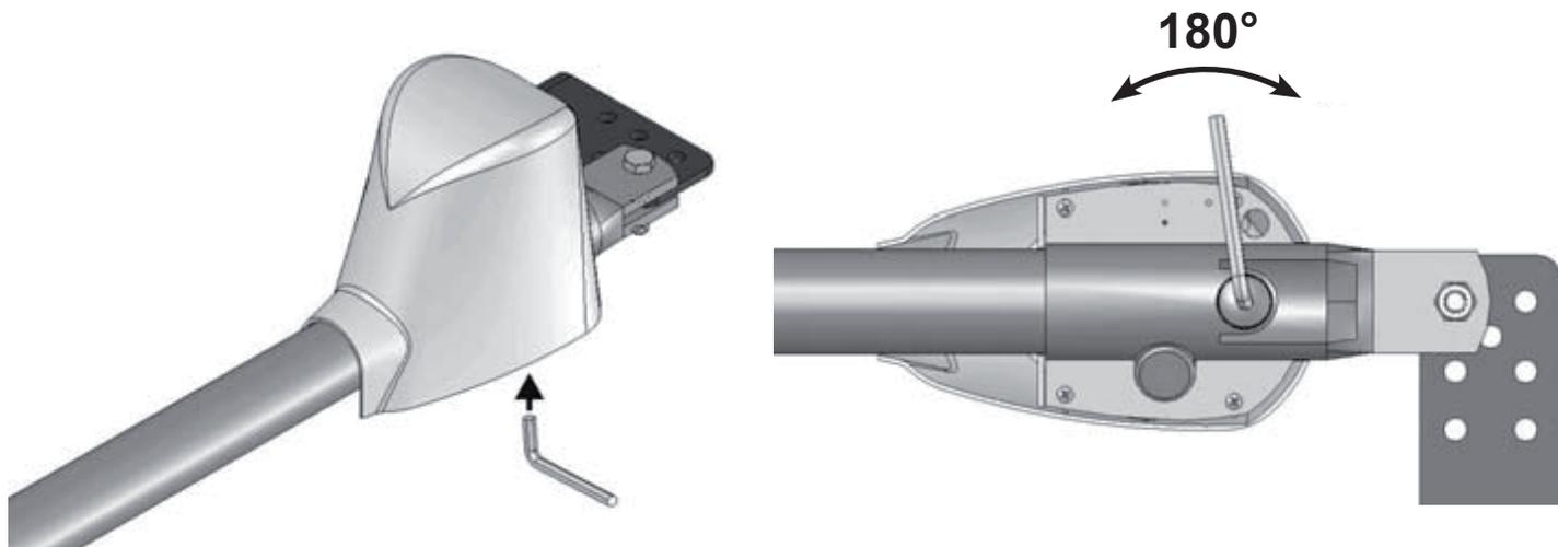
Pour verrouiller de nouveau le moteur, introduire la clé six pans servant au déverrouillage, puis la tourner de 180° dans l'autre sens.
