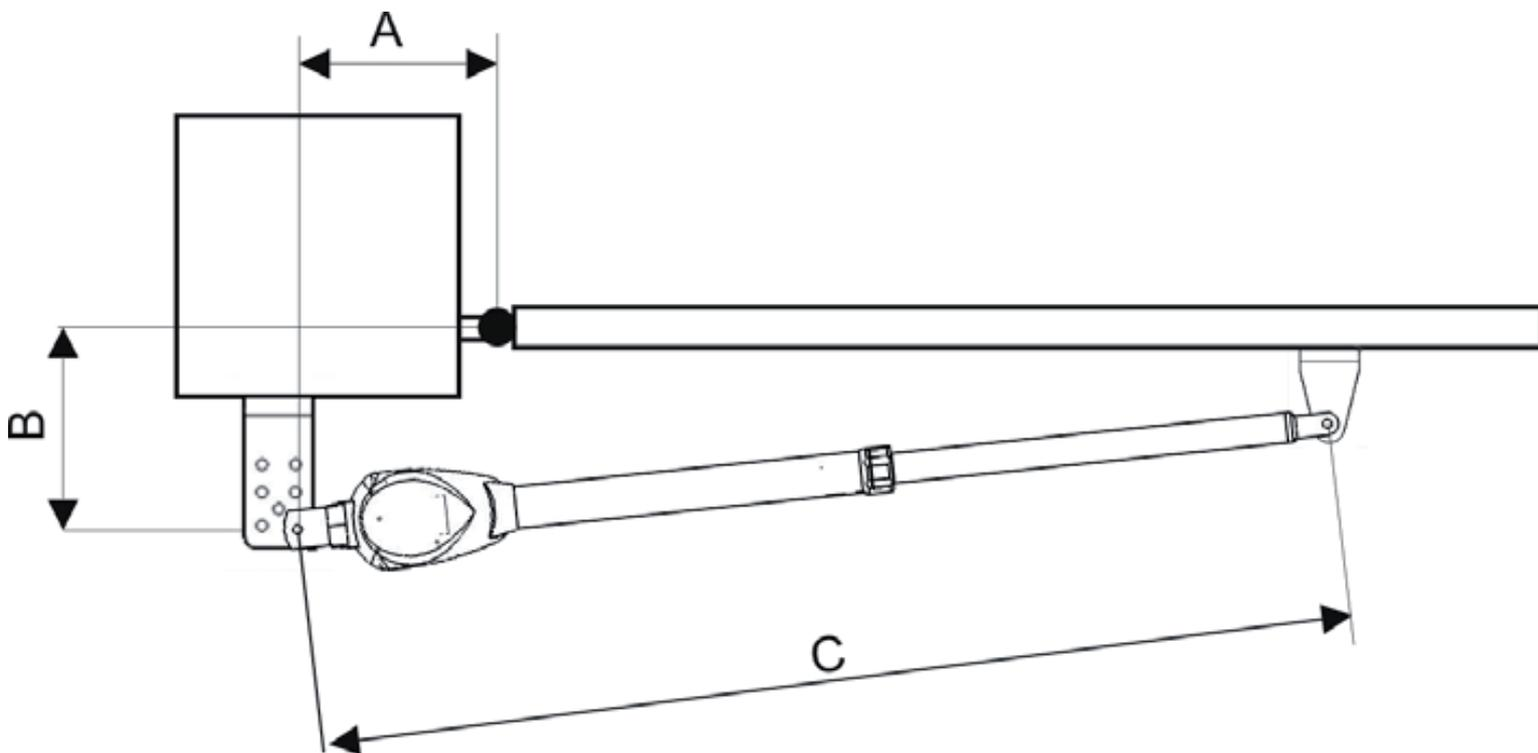
Avant de fixer vos moteurs et en fonction de l'ouverture dont vous avez besoin (en degré °), calculer le positionnement de vos moteurs sur les piliers et sur le portail.
