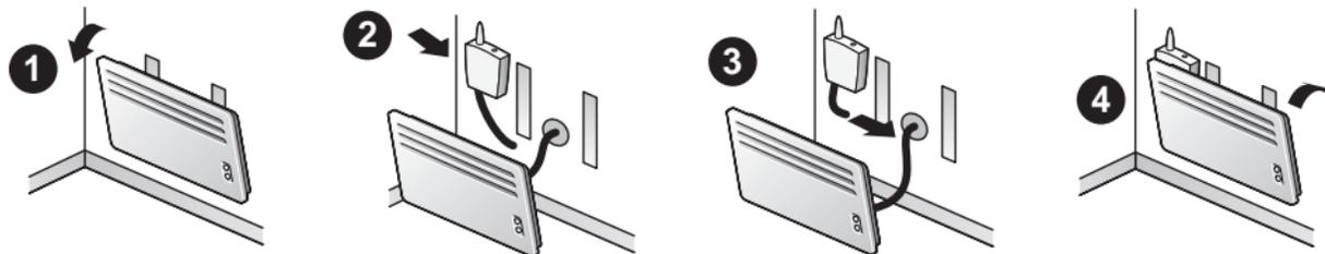
**Attention :** la température de fonctionnement du récepteur ne doit pas dépasser 50°C. Vous ne devez pas installer le récepteur trop près des parties les plus chaudes du convecteur.
