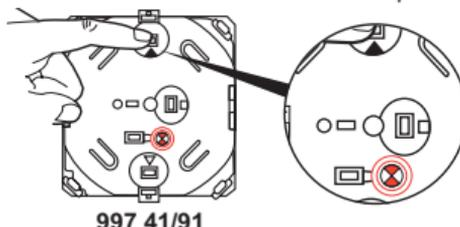
(Appui sur la touche de commande "montée" : le voyant clignote plus vite)
