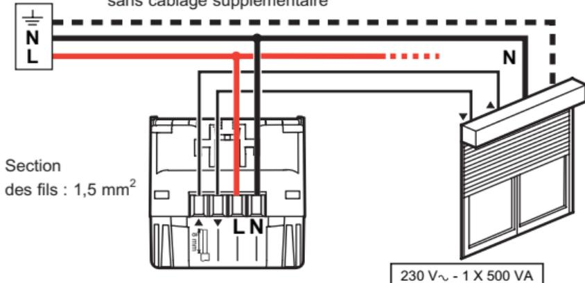
**Nota :** un inter individuel avec orientation de lamelles Radio commande un seul moteur.
