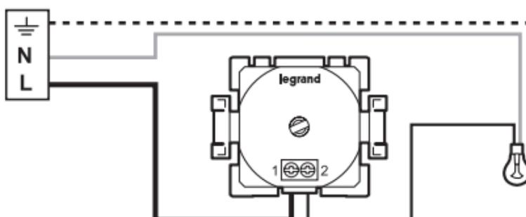
En halogène TBT à transformateur ferromagnétique
