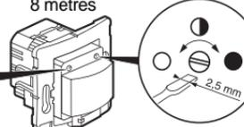
Réglage seuil de luminosité (3 à 1000 lux)
