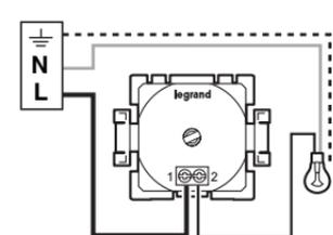
En halogène TBT à transformateur
