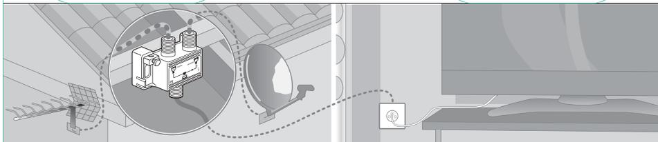
Pour réunir sur un seul câble les signaux captés par les différentes antennes terrestres et satellites sans perturbation mutuelle - Compatible avec la TNT et la HDTV.
