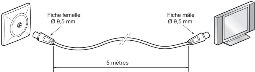
Câble blindé haute qualité 21 VA7C, spécial faible atténuation (21 décibels d'affaiblissement maxi à 800 Mhz pour 100 m de câble coaxial)
