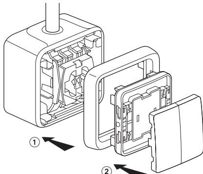
Le verrouillage IP55 de la partie avant (couvercle) sur la boîte est assuré par le pivotement de quatre 1/4 de tour.
