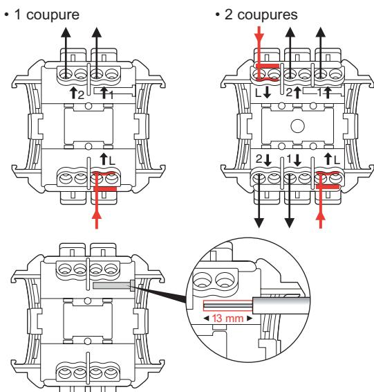
La longueur de dénudage nécessaire est de 13 mm. Un gabarit en face arrière du socle facilite le dénudage à la bonne longueur.
