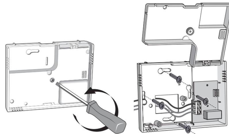
Des cloisons (repère ❸) défonçables avec une pince sont prévues pour laisser passer les câbles de raccordement si nécessaire.
