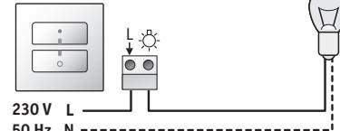
Le récepteur est compatible avec : les lampes à incandescence (💡) et les lampes halogènes 230V (💡).
