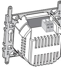
Ontbloting van de aansluit-snoeren : ~12 mm
