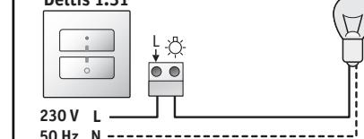
De ontvanger is compatibel met : gloeilampen ( ) en halogeenlampen van 230 V ( ).
