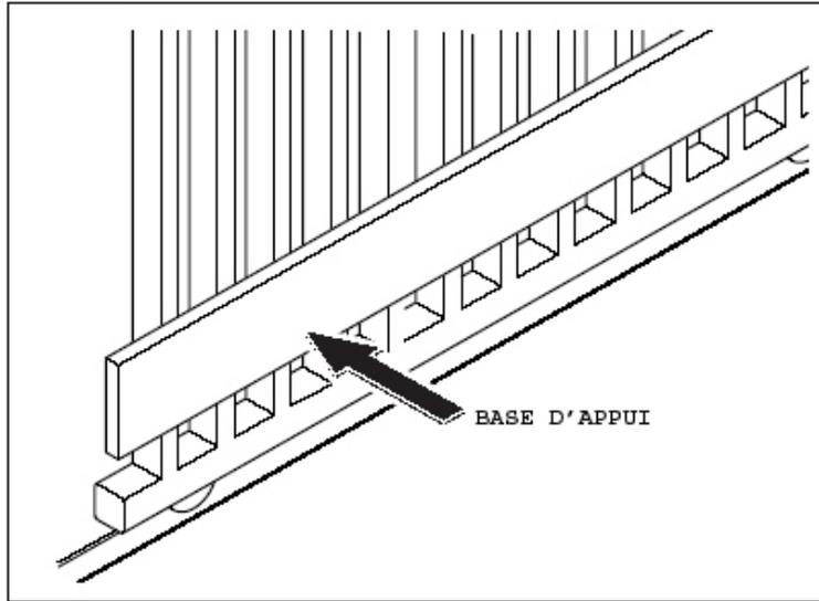
La hauteur de crémaillère doit être réglée de façon que le poids du portail ne repose jamais sur le pignon du moteur. Emboîtez chaque nouvel élément de la crémaillère dans l'élément précédent, vérifiez l'horizontalité, tracez, percez. (Voir schémas).
