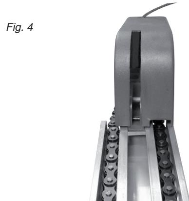
Positionner le rail (fig.5). Présenter le bloc moteur (1) face au rail (2) et emboîter celui-ci jusqu'à la butée (fig.3). Monter la chaîne dans le pignon (4). Présenter la pièce 6 et visser les deux afin de maintenir l'ensemble (rail et bloc moteur). Ne pas oublier de mettre les vis (5).
