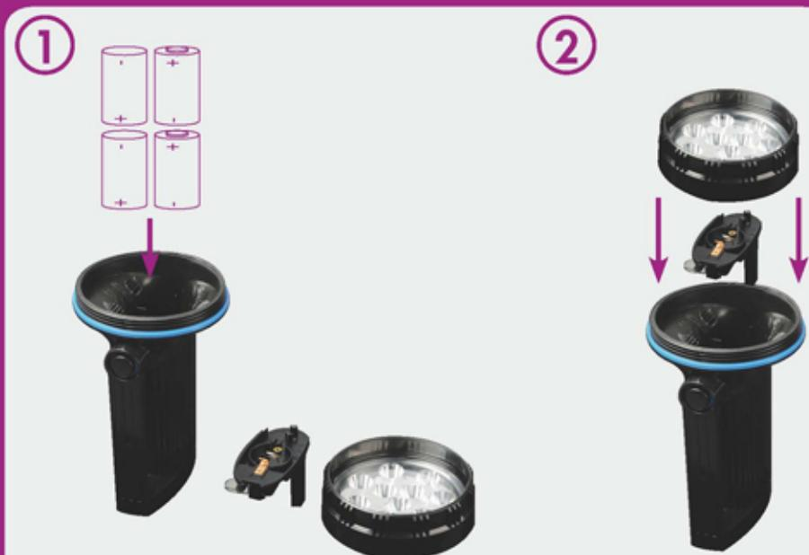
1. Démontez la tête de la lampe et insérez les 4 piles LR20 / D
