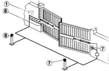
Si les photocellules sont placées sur les piliers du portail, alors elles doivent être mises du côté extérieur de la propriété si le portail s'ouvre à l'intérieur et elles seront mises à l'intérieur si votre portail s'ouvre vers l'extérieur. En aucun cas le portail doit venir faire obstruction entre les deux photocellules.
