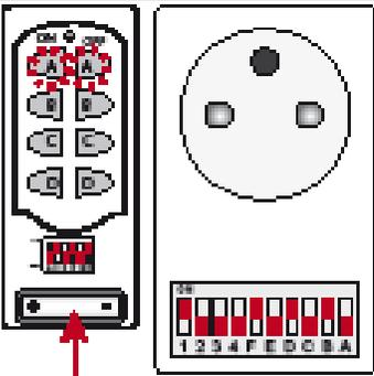
1/ Retirer la languette dans le compartiment de la pile (12V) de la télécommande.
