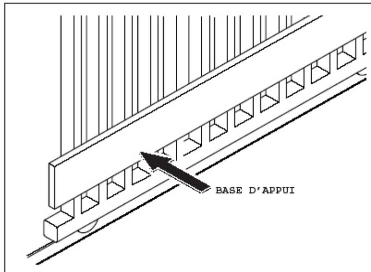
La hauteur de crémaillère doit être réglée de façon que le poids du portail ne repose jamais sur le pignon du moteur. Emboîtez chaque nouvel élément de la crémaillère dans l'élément précédent, vérifiez l'horizontalité, tracez, percez. Voir schémas. Ne JAMAIS graisser la crémaillère.
