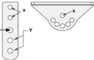
**important** - pour obtenir la longueur de la fixation (L) la plus adaptée, déterminer la position d'assemblage des deux plaques (utiliser toujours le trou X plus l'un des 5 trous disposés en arc de cercle), puis choisir le trou servant à fixer l'opérateur parmi les 2 trous dédiés Y.
