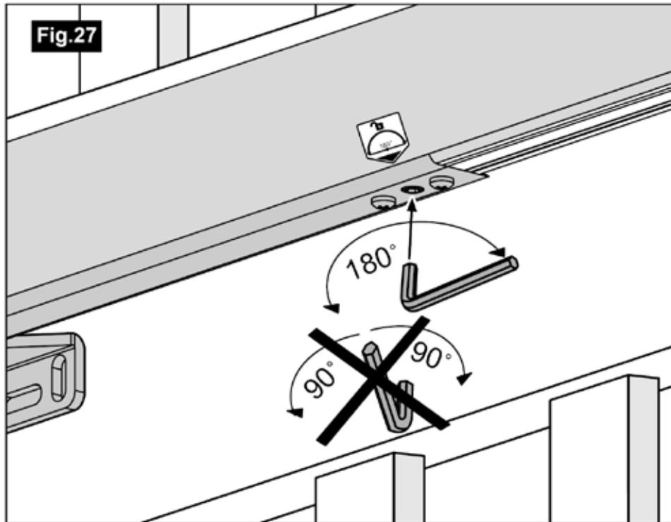
Placez-vous du côté intérieur du portail. Introduire la clé six pans servant au déverrouillage, puis la tourner de 180° (fig. 27).
