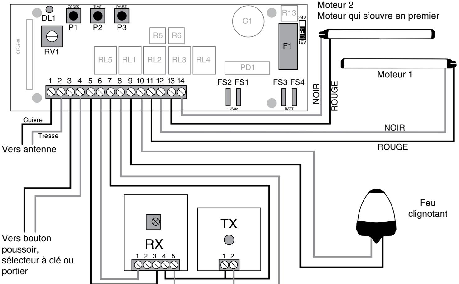
**Note:** Si vous n'utilisez pas de photocellules, pontez impérativement les bornes 5 et 6 ensemble à l'aide un fil électrique.
