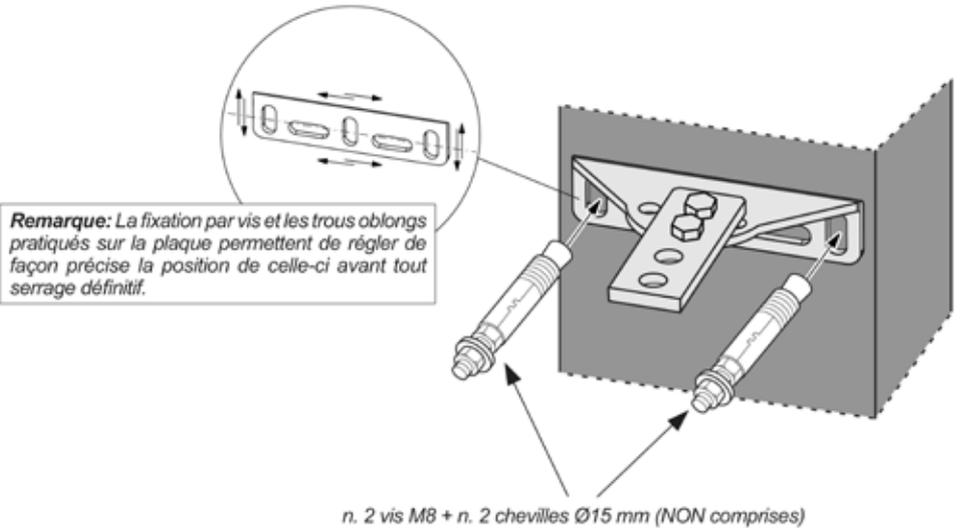
**NOTE:** Les fixations des moteurs ACCESS 5001 peuvent être utilisées en de multiples positions : L'attache côté pilier autorise trois possibilités de montage :
