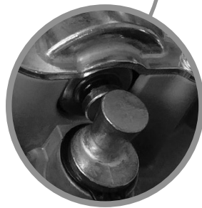
Position du moteur déverrouillé : Le téton doit être en position enfoncée
